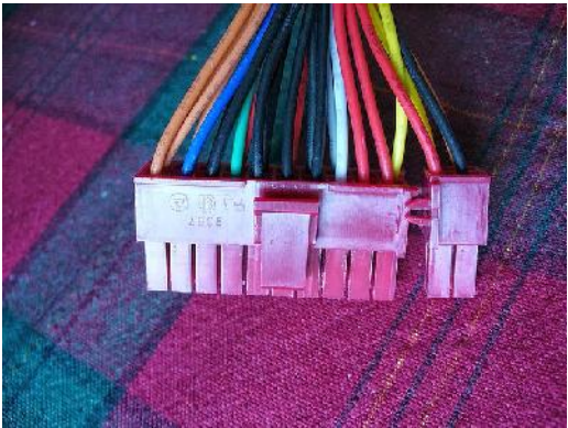
Gambar 58. Konektor PIN 20/24 ATX
