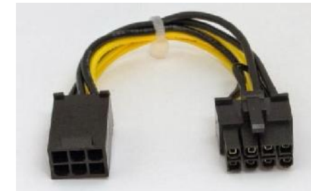
Gambar 60. Konektor 6 PIN AUX
